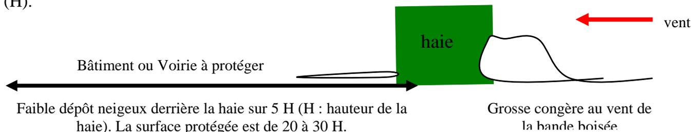
**Intérêt :** ce type de réalisation bloque la neige "au vent" de la bande boisée, ce qui empêche son dépôt du côté sous le vent. Cette haie doit être implantée à 5 fois la hauteur de la haie de la surface à protéger pour éviter le faible dépôt neigeux "sous le vent". Les arbres, disposés en bandes, interceptent également la neige, le brouillard et la bruine.
