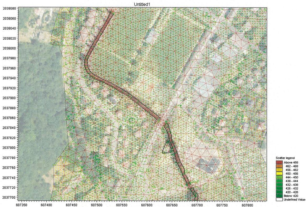
*Illustration 2 : Exemple du maillage du modèle hydraulique*
